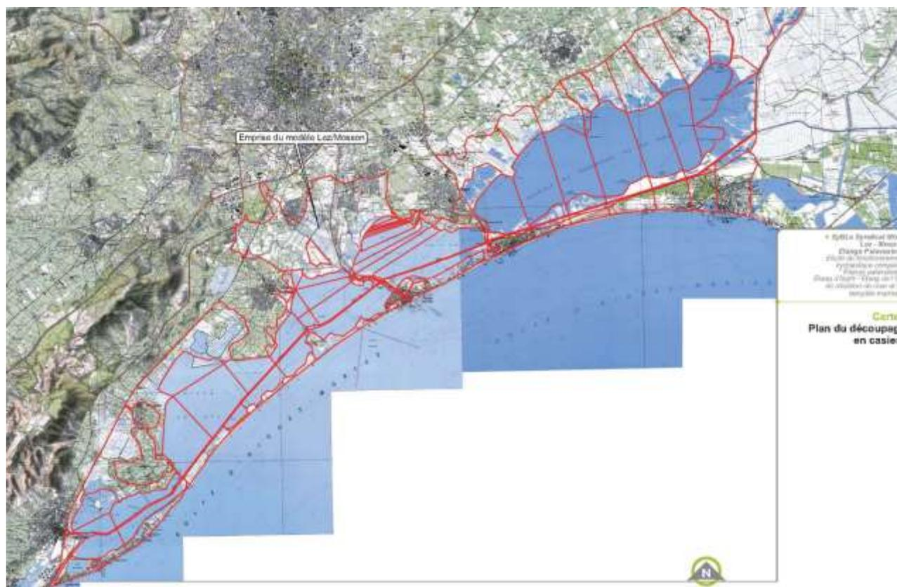
Figure 14 : Structure du modèle hydraulique du complexe des étangs palavasiens, de l'Or et d'Ingril
