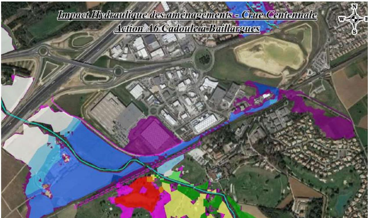
Figure 23 : zone mise hors d'eau par le système de protection de Profil Systeme – objectif de protection 100 ans
