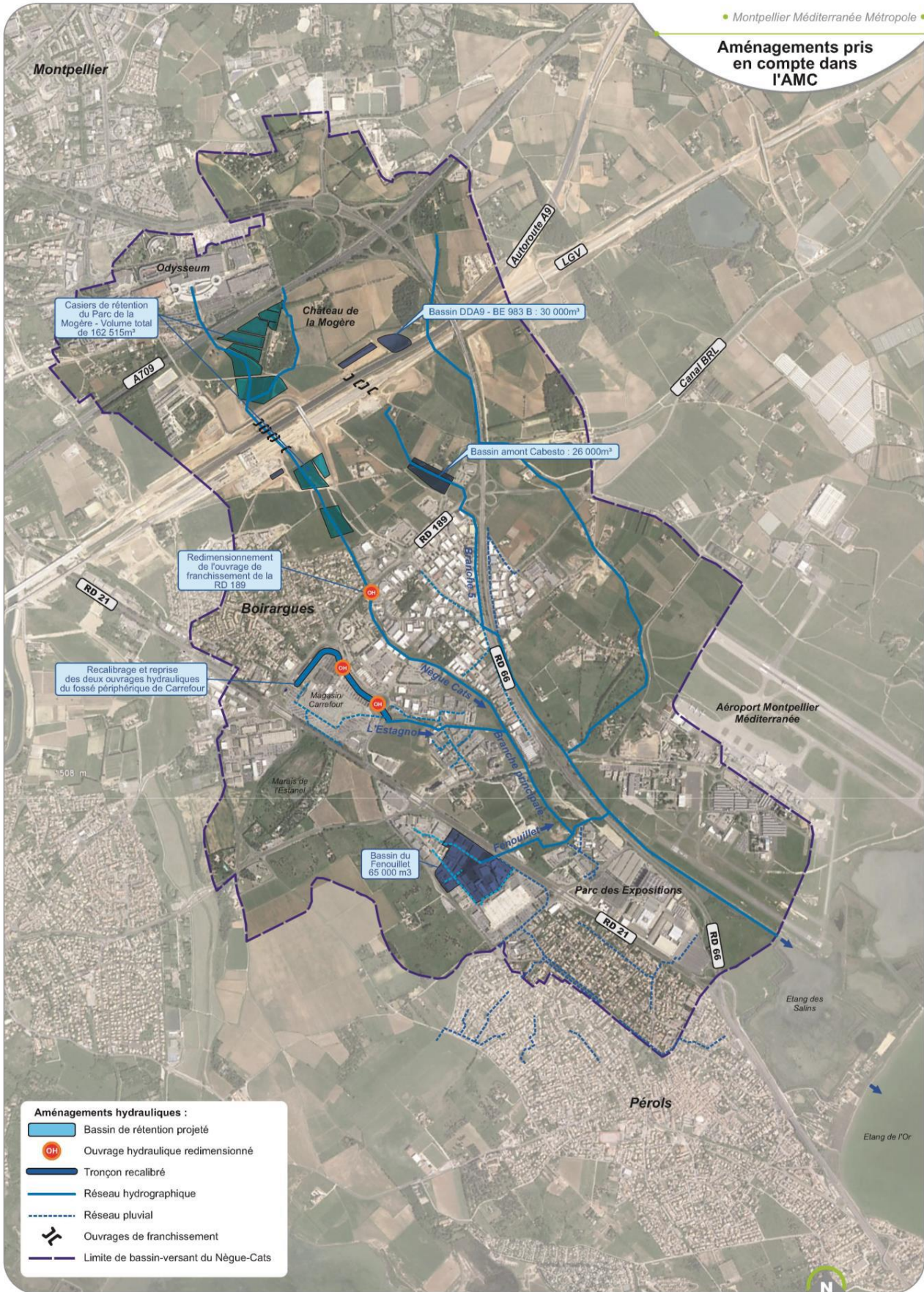
Implantation des aménagements du Schéma Directeur hydraulique du Nègues-Cats
