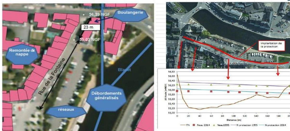
Figure 54 : Hydraulique des crues rue de la fontaine
