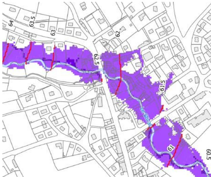
Figure 27 : Aléa centennal modélisé dans le bourg de Stival (Source : DDTM56)
