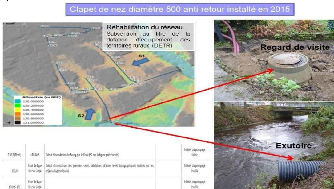
Figure 53 : Installation d'un clapet anti-retour sur la commune de Gouarec
