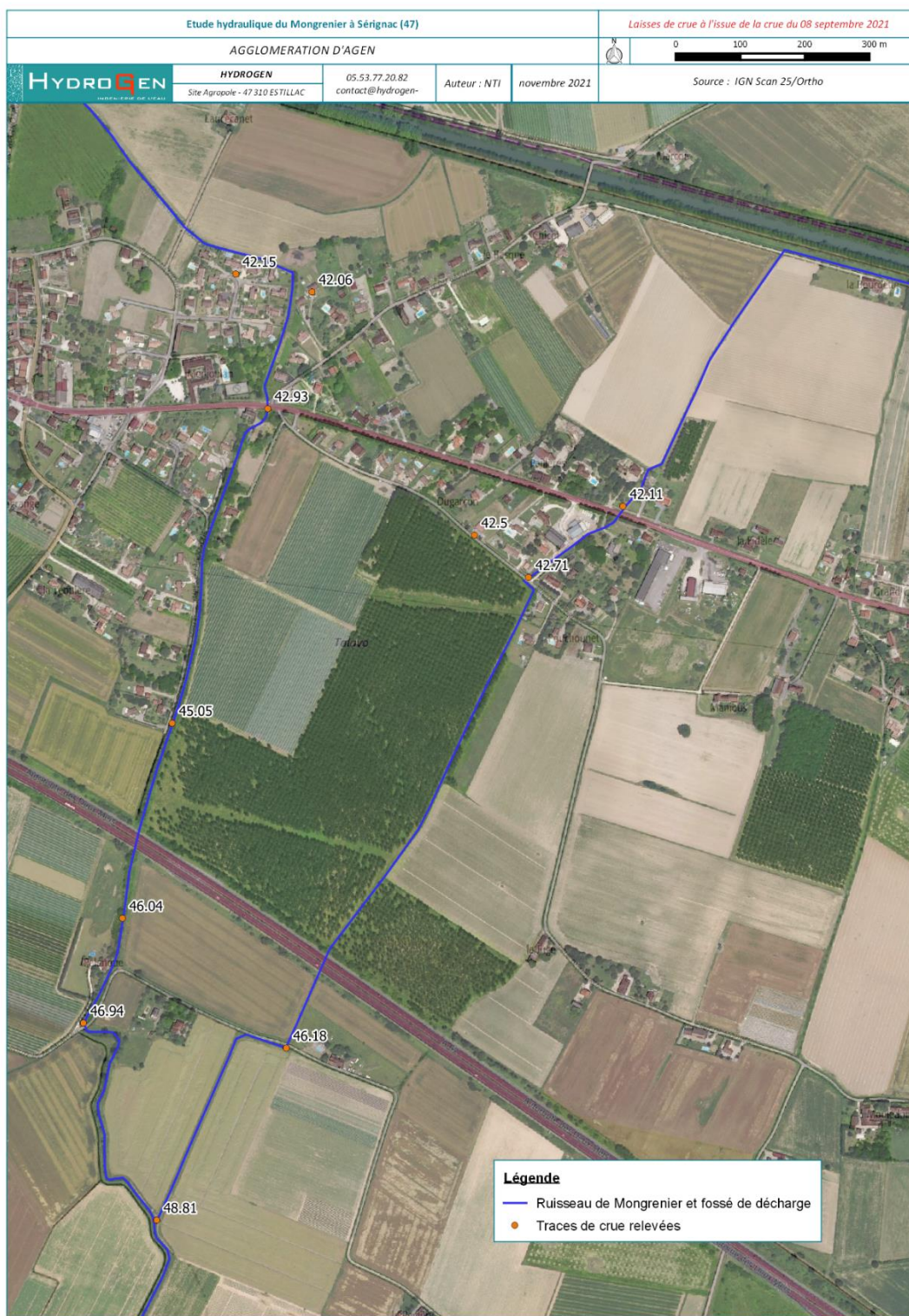
Figure 38. Laisses de crues relevées (crue de septembre 2021)
