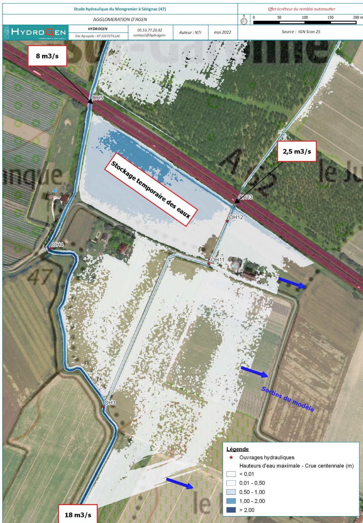
Figure 52. Hauteurs d'eau en cas de crue centennale au niveau du remblai autoroutier
