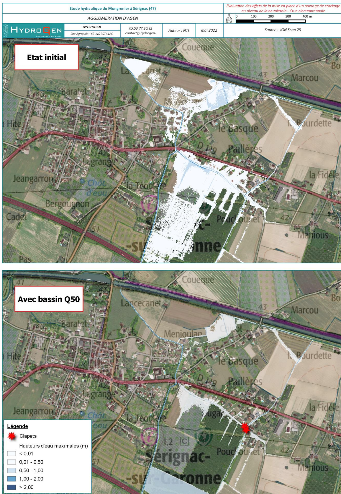
Figure 66. Effets du bassin de stockage BR50 sur la crue cinquantennale
