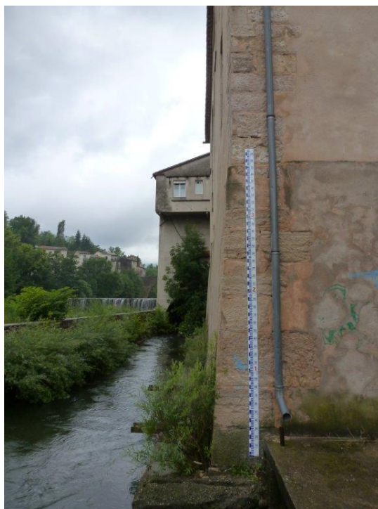
Echelle limnimétrique au Vigan
