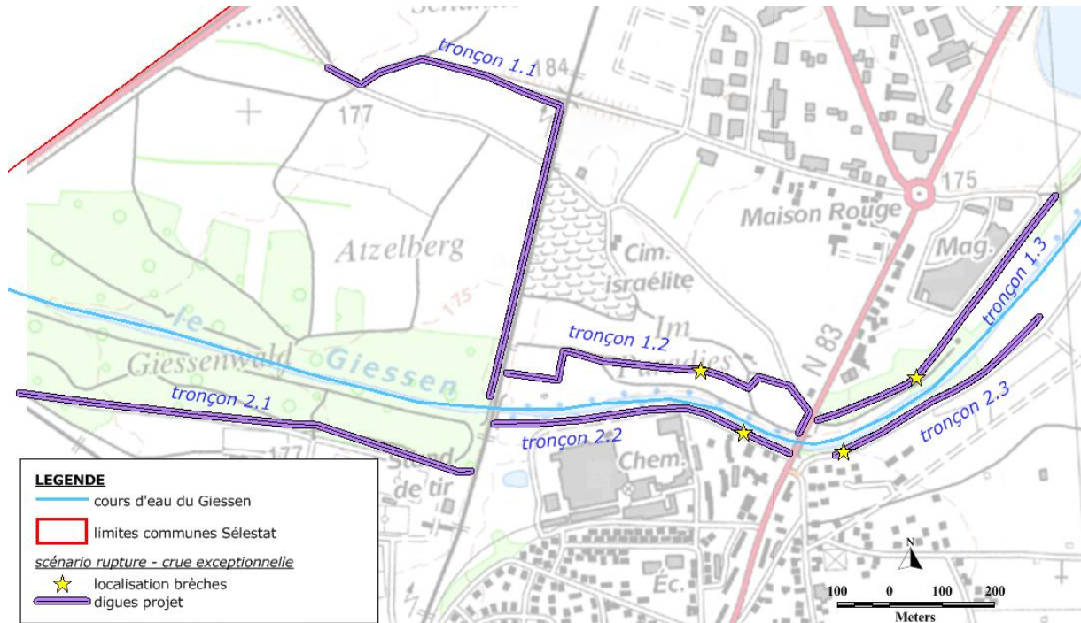
Figure 13 : zones de rupture probables des digues
