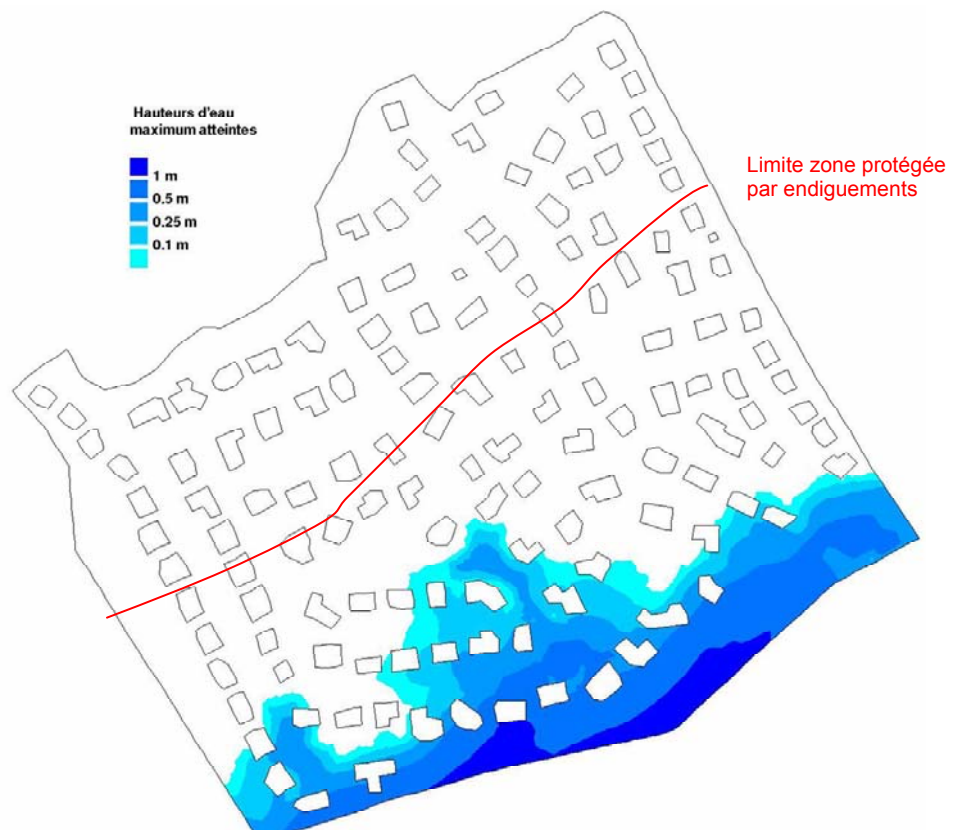
Scénario 1 : Cartographie des hauteurs d'eau maximales sur la durée de la simulation
