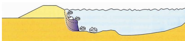
Figure 31 : Mécanismes de rupture par érosion externe
