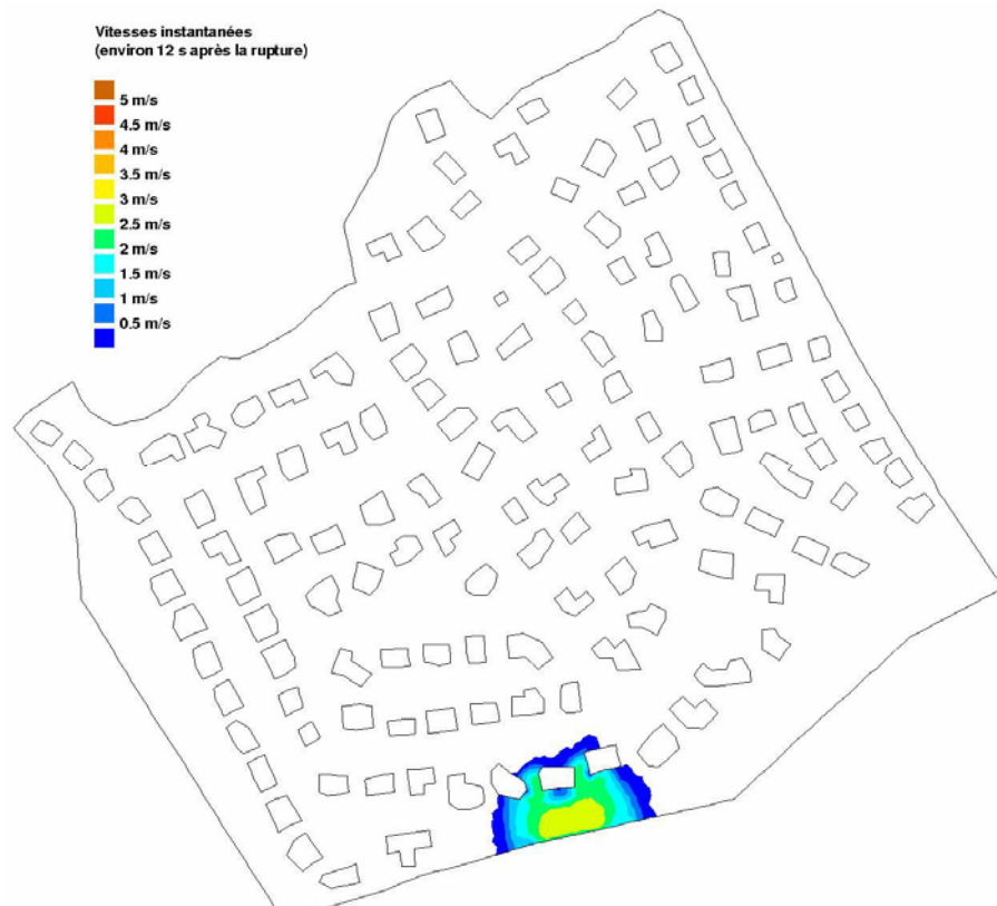
Scénario 1 : Cartographie des vitesses d'écoulement à 12s
