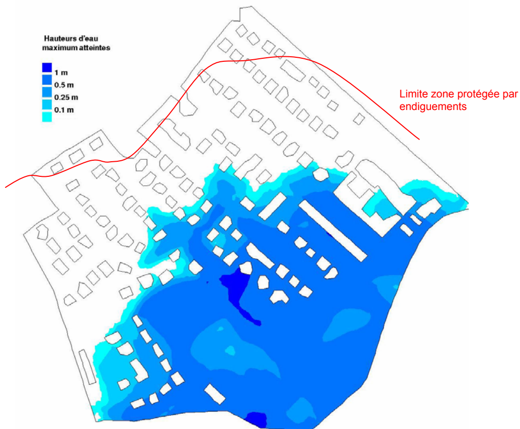
Scénario 2 : Cartographie des hauteurs d'eau maximales sur la durée de la simulation
