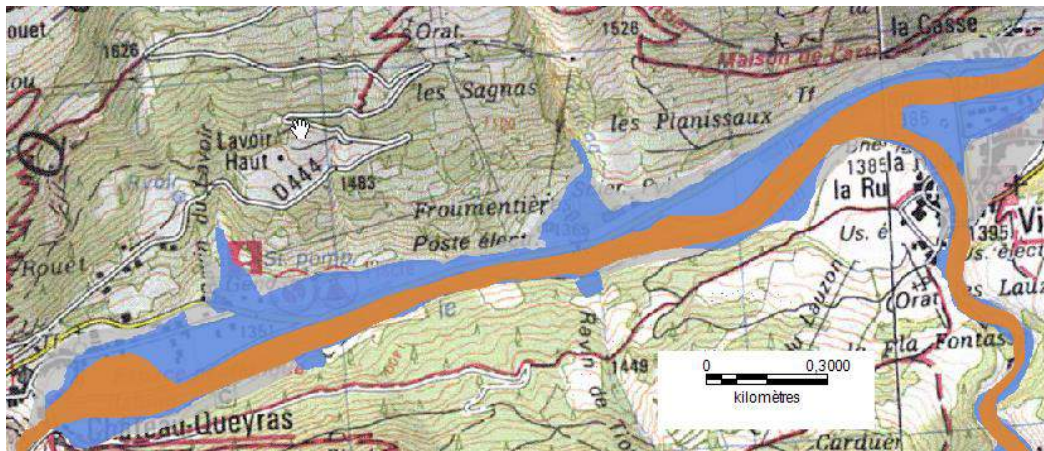
11-a : emprise des zones inondables du Guil entre Château Queyras et Ville Vieille
