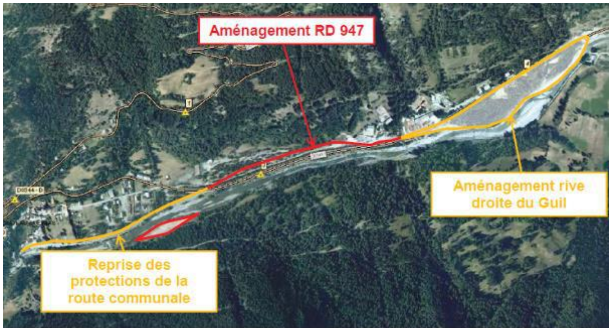
Figure 19 : Travaux d'aménagement de la RD 947 et le recul de la digue (source : Conseil Départemental, 2016)
