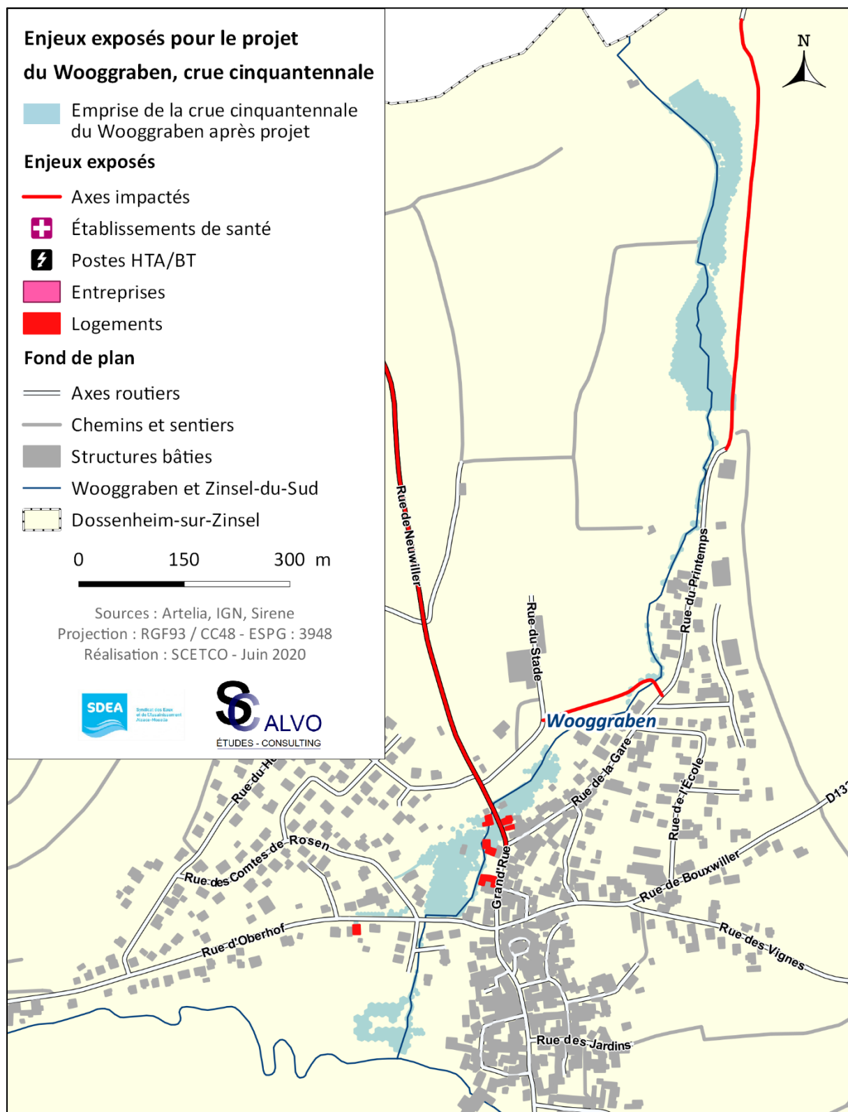
Figure 7 - Enjeux exposés sur le Wooggraben après aménagements, crue cinquantennale
