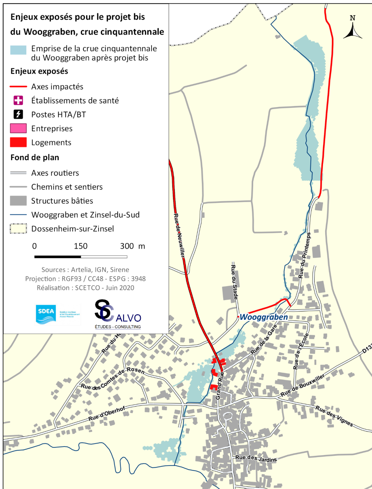
Figure 20 - Enjeux exposés sur le Wooggraben après aménagements bis, crue cinquantennale
