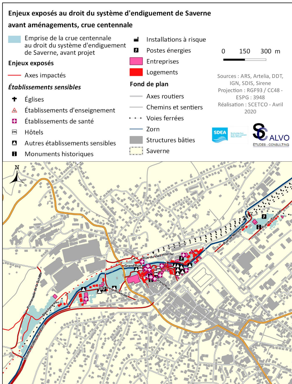
Figure 8 - Enjeux exposés au droit du système d'endiguement de Saverne avant projet, crue centennale
