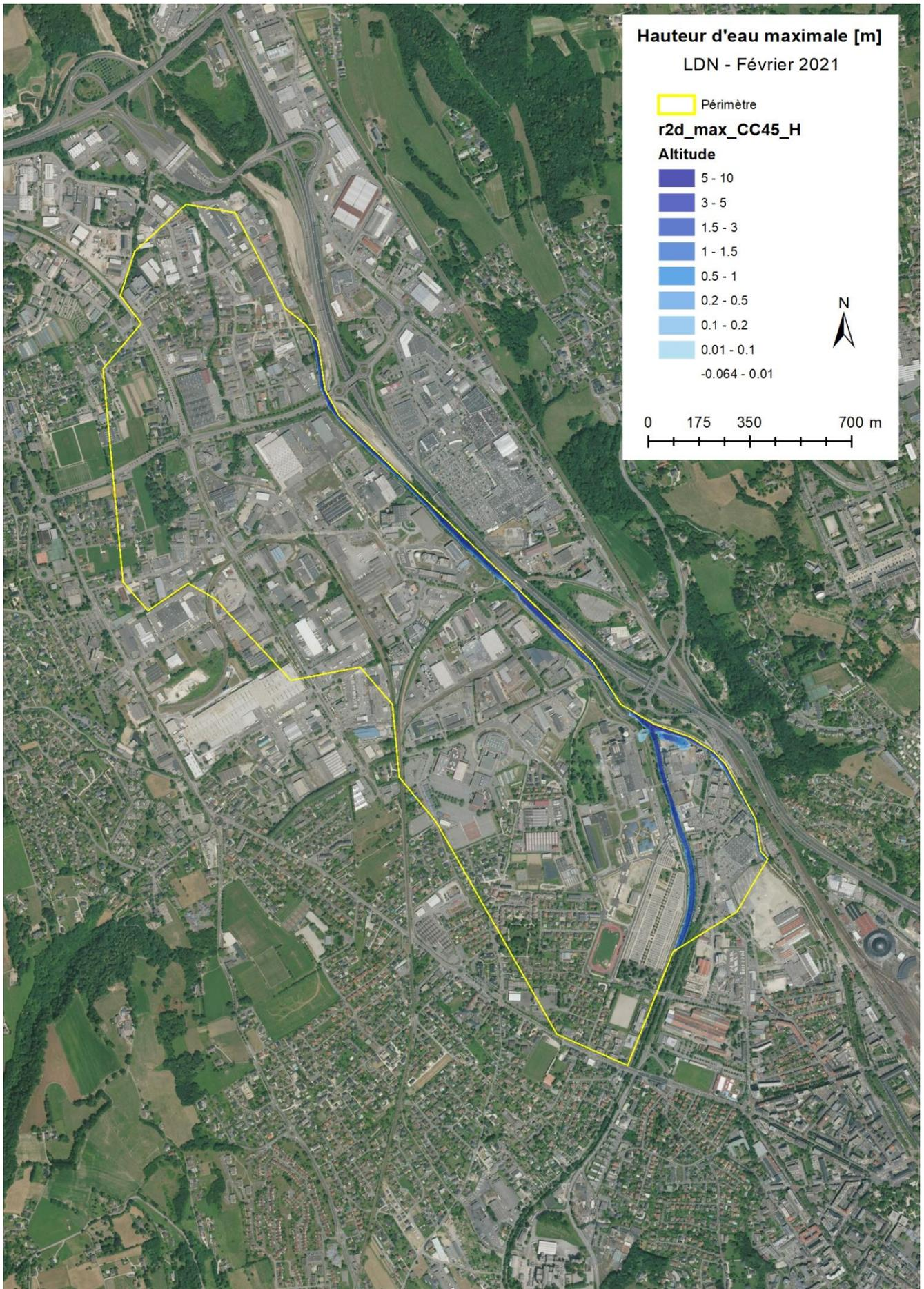
Figure 9 : Etat projet – Q100 – Sans rupture
