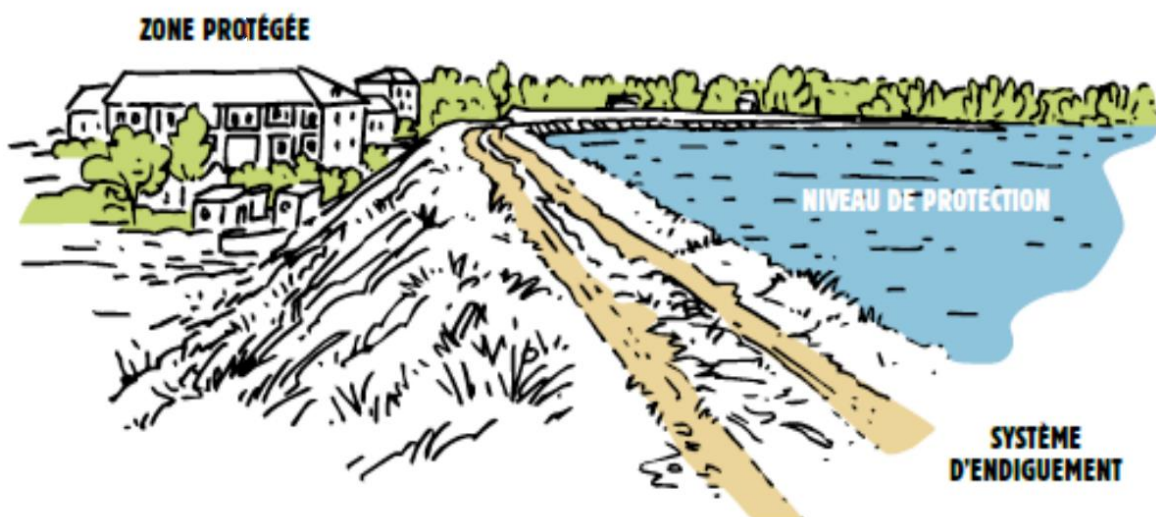
Figure 2 : Illustration d'un système d'endiguement et de sa zone protégée [source : CEPRI]
