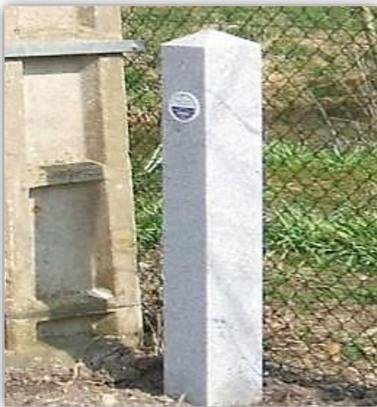
Photographie 8: Repère de crue posé sur une borne en granit à Fontaine-sur-Somme
