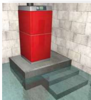
Figure 7: Surélévation des installations sensibles
