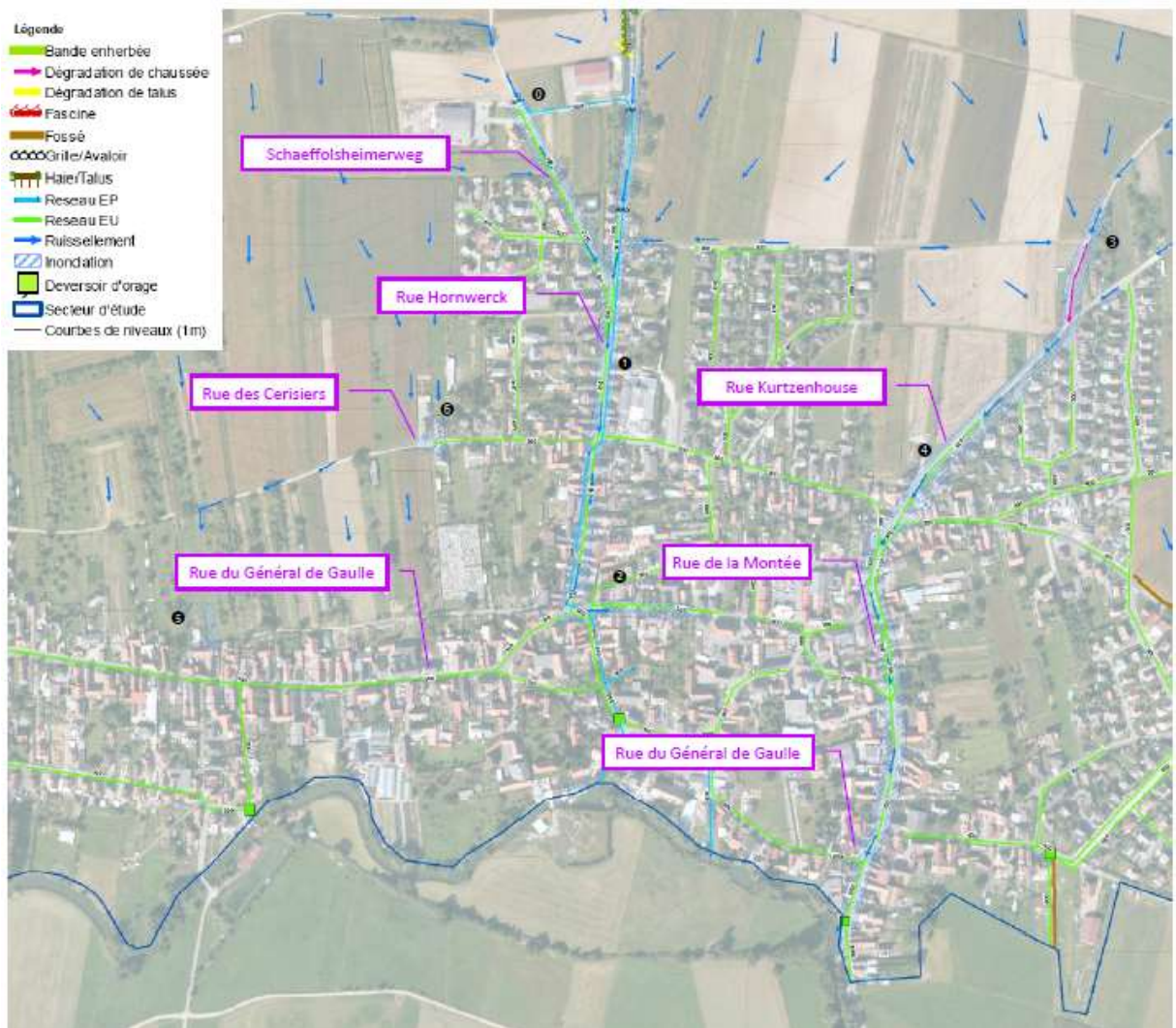
Figure 89: Carte de l'état des lieux de Geudertheim avec les différents points de désordres hydrauliques (Anteagoup 2011)
