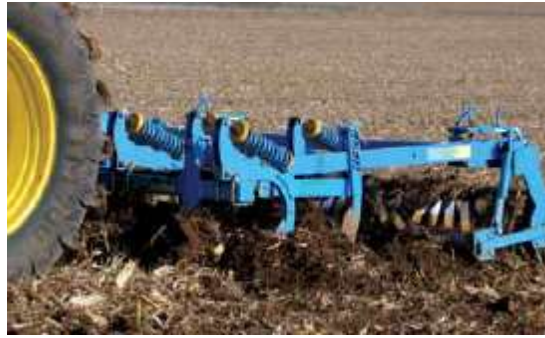
Figure 120 : Le déchaumeur, un outil de technique sans labour Source : CD67
