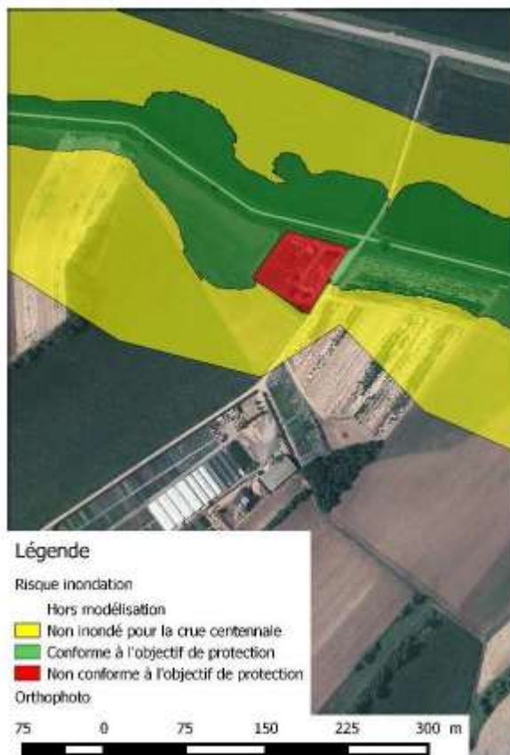
Figure 78: Risque inondation, station d'épuration, Berstett (Berest, 2014)
