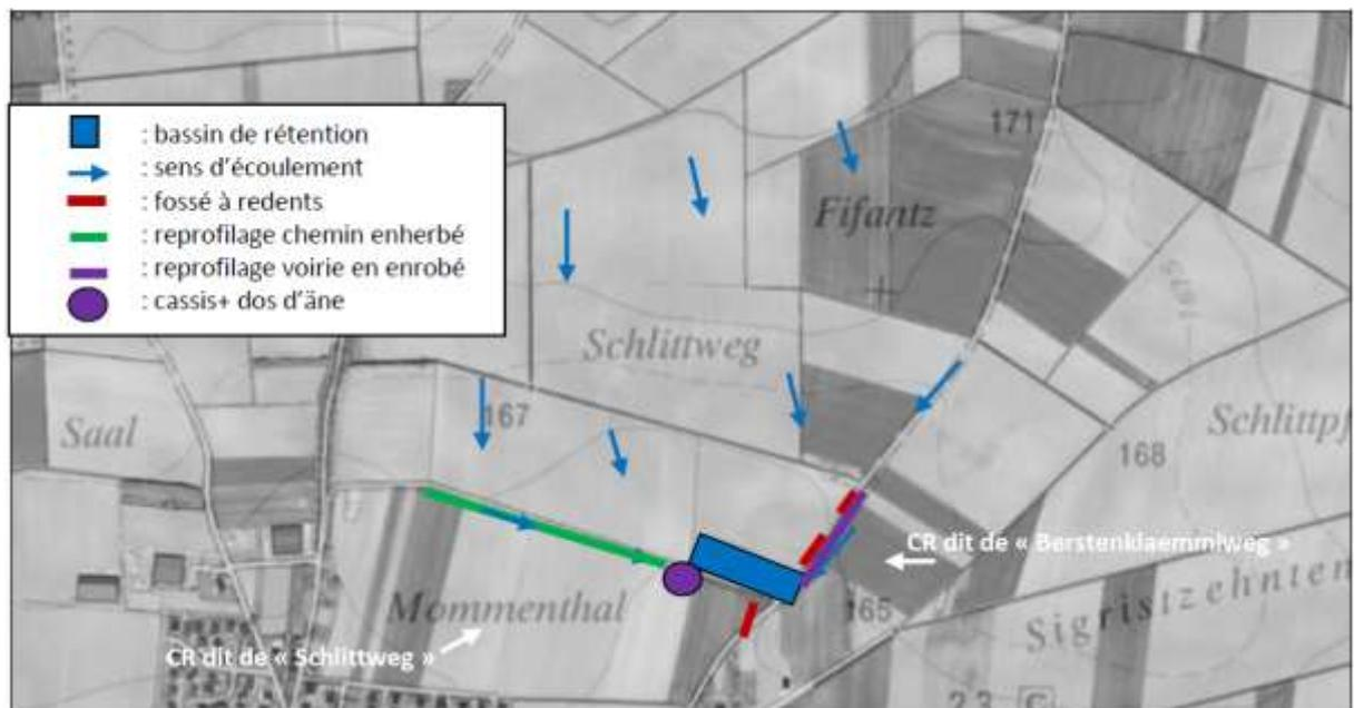
Figure 13: Principe de fonctionnement de l'ouvrage de rétention A1010, à Geudertheiml
