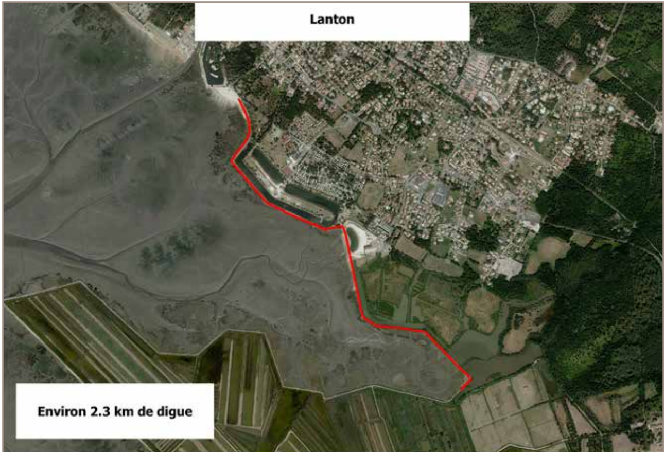
Illustration 15 : Carte des ouvrages de protection contre la submersion marine de Lanton (SIBA, 2017)
