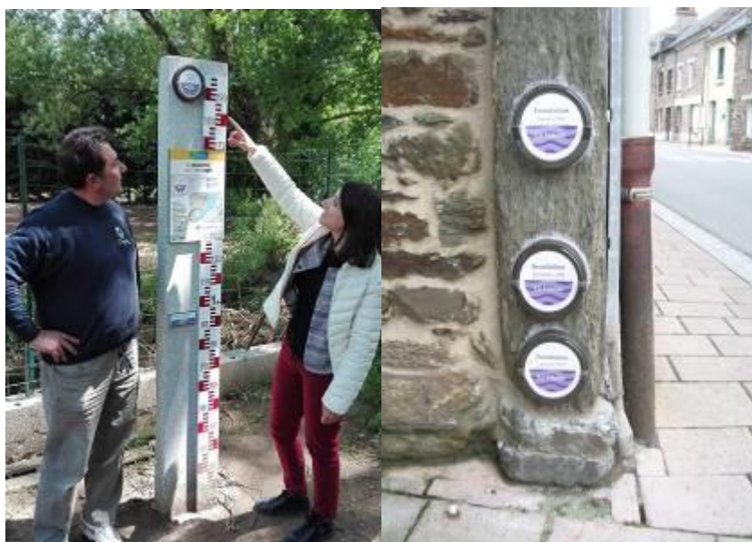
Figure 600 : exemples de repères de crue sur support propre (à gauche, couplé avec échelle et panneau didactique) ou intégrés au bâti (à droite)
