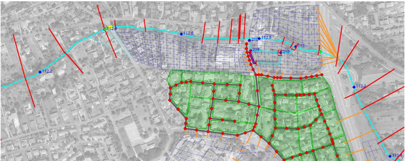
Extrait de l'architecture du modèle hydraulique sur l'agglomération de Riom (Etude Hydratec 2014)
