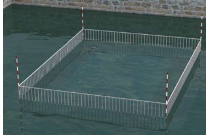
La barrière de sécurité reste visible tant que le niveau de l'eau est inférieur à sa hauteur
