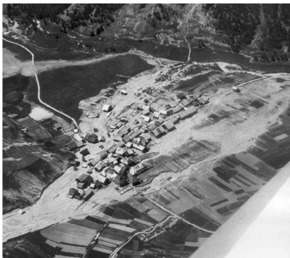
Photo 3.1 : Divagation et alluvionnement incontrôlés d'un torrent - Ceillac
