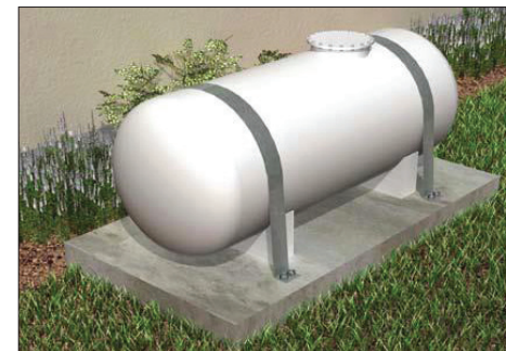
Arrimage des cuves de fioul
