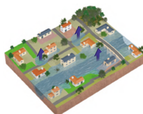
Remontée de nappe
